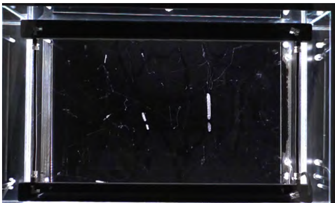
Vue plongeante d'une chambre à brouillard.
